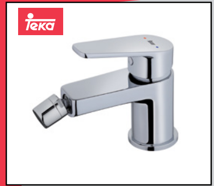
MONOMANDO BIDÉ Aireador anticalcáreo con rótula giratoria. Sin desagüe automático. Latiguillos de alimentación flexibles 3/8".
